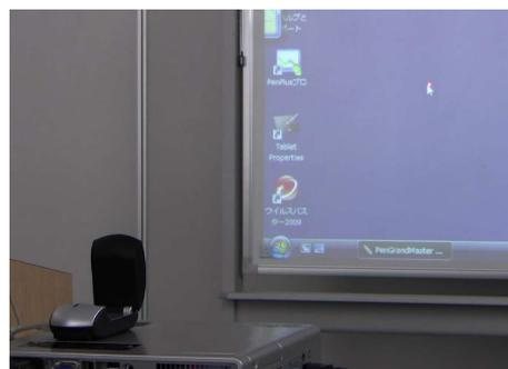
※ペン先端やレーザーの光点がセンサーユニットの視野に入るように操作して下さい。接触操作時にペン先端を投影画面に対して垂直に立てすぎたり、ペン先端やレーザー光点が右図のように身体などの影に隠れていたりすると、センサーユニットが光を検知できず、操作できなくなります。
