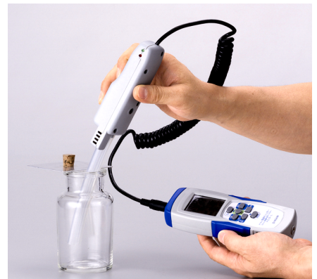
気体採取ホースを集気びんに挿入した状態
